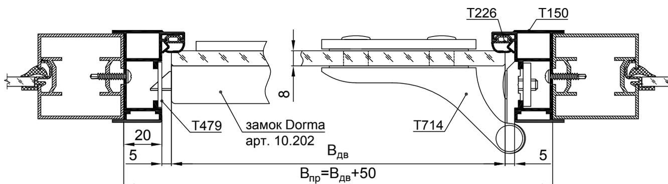
Рис. 5.7 Установка цельностеклянного дверного полотна толщиной 8 мм
