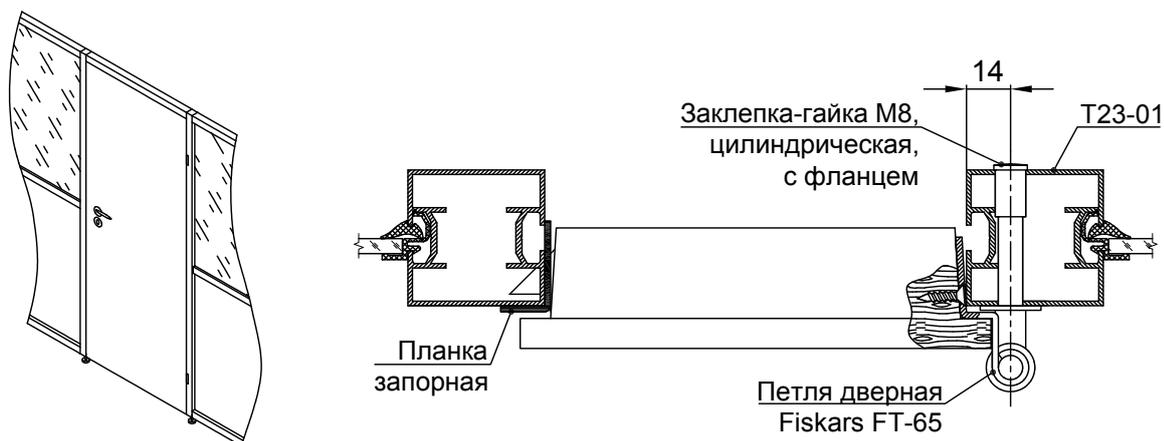
Рис.7.2 Установка деревянной двери с притвором толщиной 40 мм без использования дверной коробки
