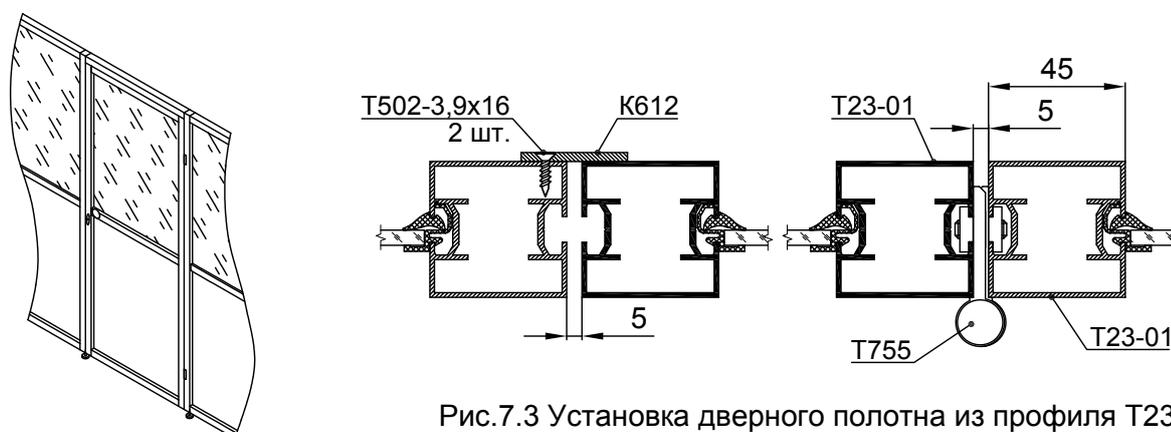
Рис.7.3 Установка дверного полотна из профиля T23-01 без использования дверной коробки
