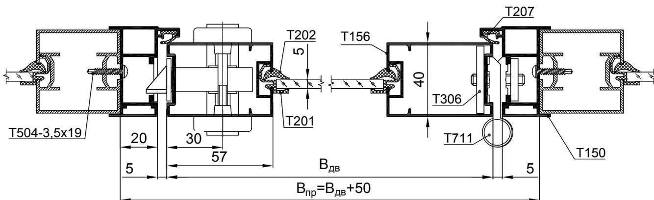
Рис. 5.5 Установка дверного полотна из профиля Т156
