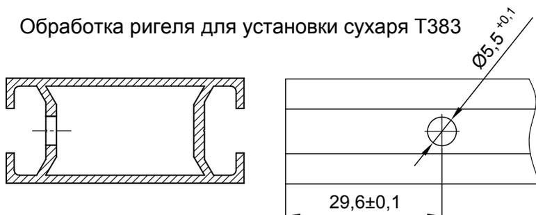
Отверстие  $\text{Ø}5,5$  мм целесообразно выполнять на пробойнике ПК148 с комплектом инструмента ПК344 или с помощью кондуктора ПК367.
